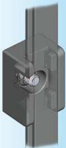
Guida asta e asta montate in trasparenza
