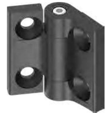
**Cerniera frizionabile 180° avvitabile in zama polverizzata nera per vite svasata M8, cono frizionabile in poliacetale POM, vite e dado in acciaio zincato**
