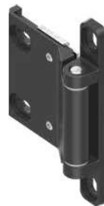
Cerniera 3D avvitabile parte centrale e ponte in zama polverizzata nera, perno assiale, piastra e perni in acciaio inox, boccole in plastica chiara
