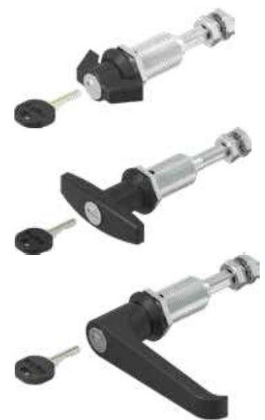
Maniglia e scatola in zama polverizzata nera, cilindro in zama con coperchio antipolvere in inox, dado e vite o rondella in acciaio zincato, con molla e guarnizione. Ogni cilindro è fornito con una chiave in acciaio speciale con impugnatura in poliammide nera. La chiave è estraibile in due posizioni.
