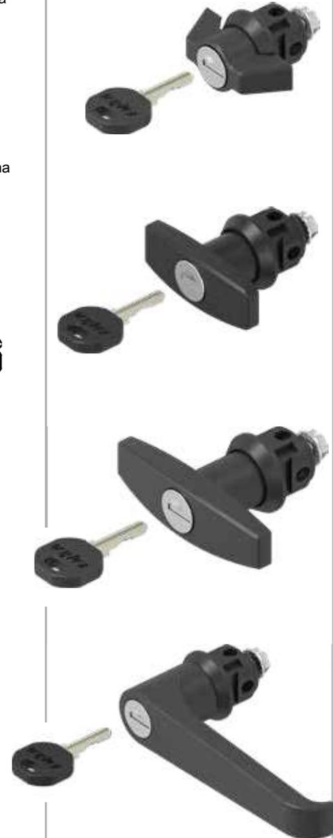
Maniglia in poliammide GF nera/zama, scatola in poliammide GF nera, cilindro in zama con copriforo antipolvere in acciaio inox, vite in acciaio zincato con guarnizione. Ogni cilindro è fornito con una chiave in acciaio speciale con impugnatura in poliammide nera. La chiave è estraibile in due posizioni.
