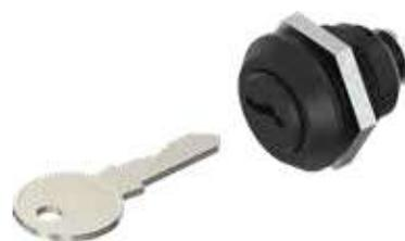
Chiusura 1/4 di giro con cilindro, scatola in zama finitura a scelta, cilindro in zama con copriforo antipolvere in acciaio inox, dado, dado per messa a terra e vite in acciaio zincato. Ogni cilindro è fornito con una chiave in acciaio speciale con impugnatura in poliammide nera.
