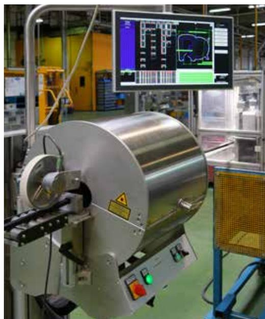
Basato su fotocamera permanente monitoraggio della geometria del profilo (PIXArgus)
