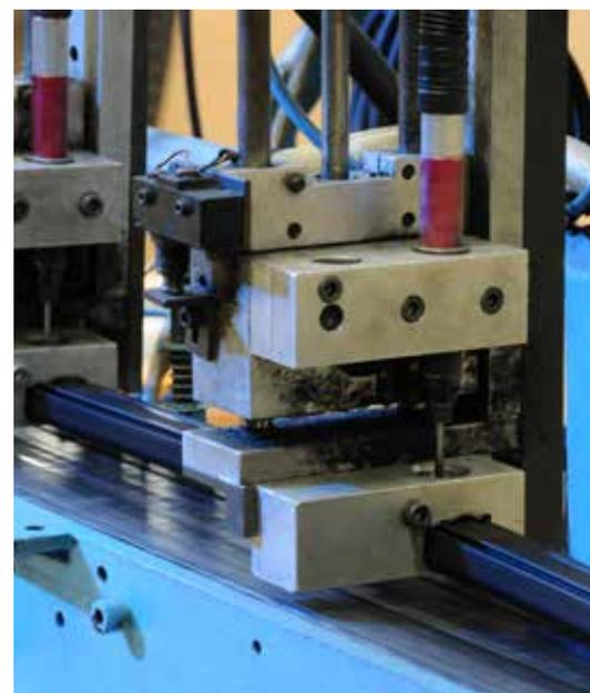
Dispositivo di perforazione per fori di ventilazione
