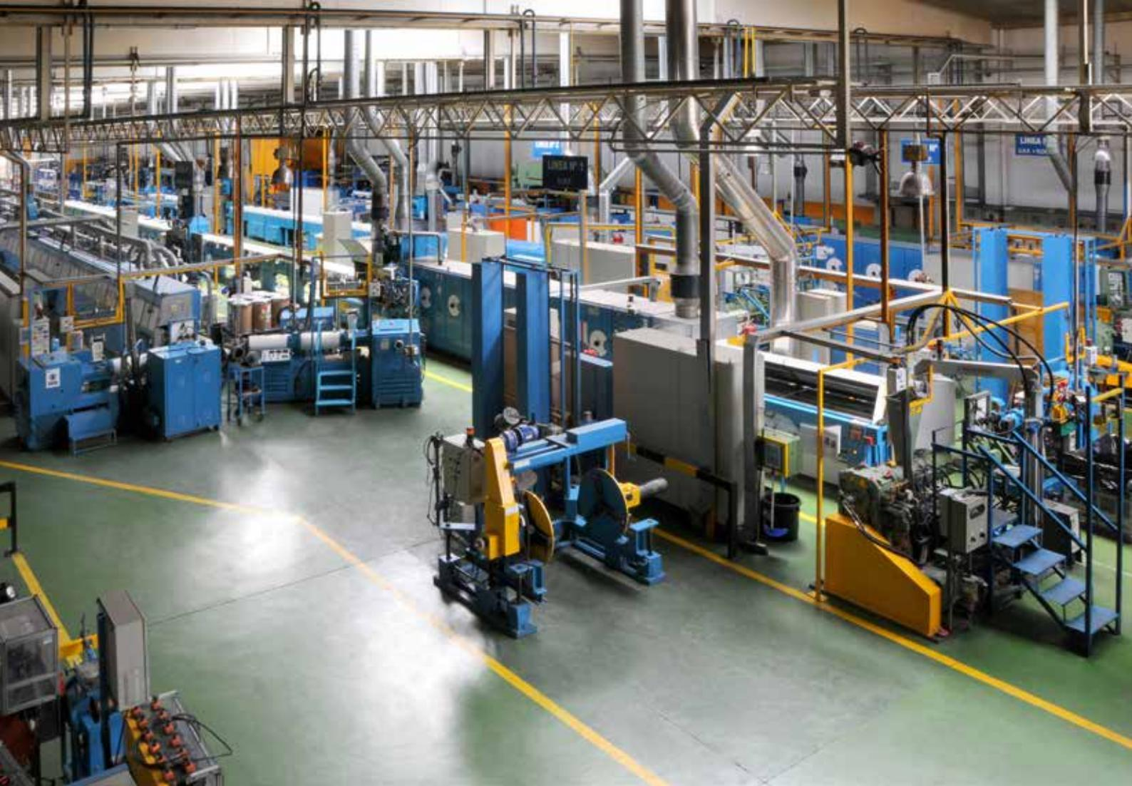
Linee di estrusione in gomma con bagno salino e vulcanizzazione UHF
