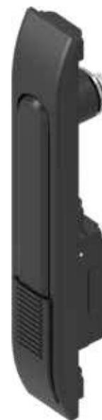
Maniglia girevole in poliammide GF nera con inserto modulare a pulsante (2100-U57), impugnatura in zama polverizzata nera, snodo in zama zincata, materiale di fissaggio in acciaio zincato, ponte di fissaggio in poliammide GF nera, con guarnizione
