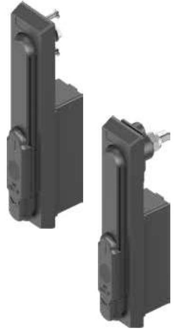
**Maniglia girevole per profilo mezzo-cilindro in poliammide nera, snodo in ottone nichelato, dispositivo di chiusura in zama con molla in acciaio zincato, materiale di fissaggio in acciaio zincato o inox con guarnizione**
