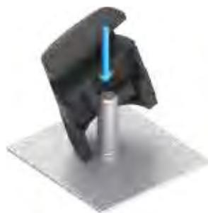
1. Mettere la guida asta sul perno saldato.
